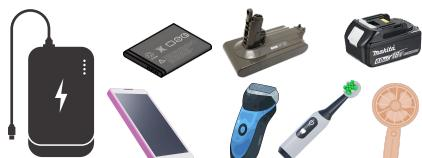
リチウムイオン電池などの小型充電式電池や、取り外しができない製品は、破損や圧迫により発火・火災の原因となるおそれがあるため、安全確保を目的として分けて回収しています。充電して使う製品はこちらに出してください。
