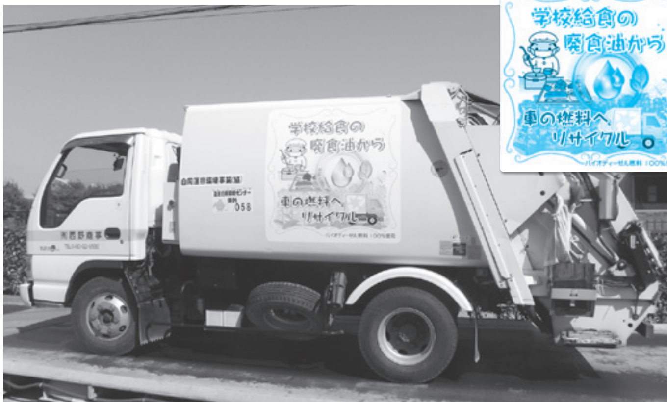
学校給食からの廃食用油を使用して走る収集車両
